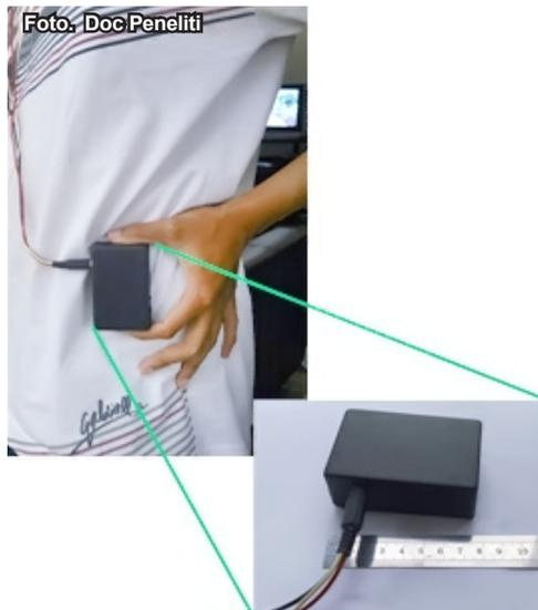
dipakai penggunaannya (*wearable*) ini mempunyai modul untuk transmisi sinyal ECG. Nantinya, sinyal ECG hasil transmisi akan ditampilkan di perangkat *mobile* berbasis Android, kemudian disimpan, diolah atau ditransmisikan ke tempat lain untuk kepentingan lebih lanjut.
